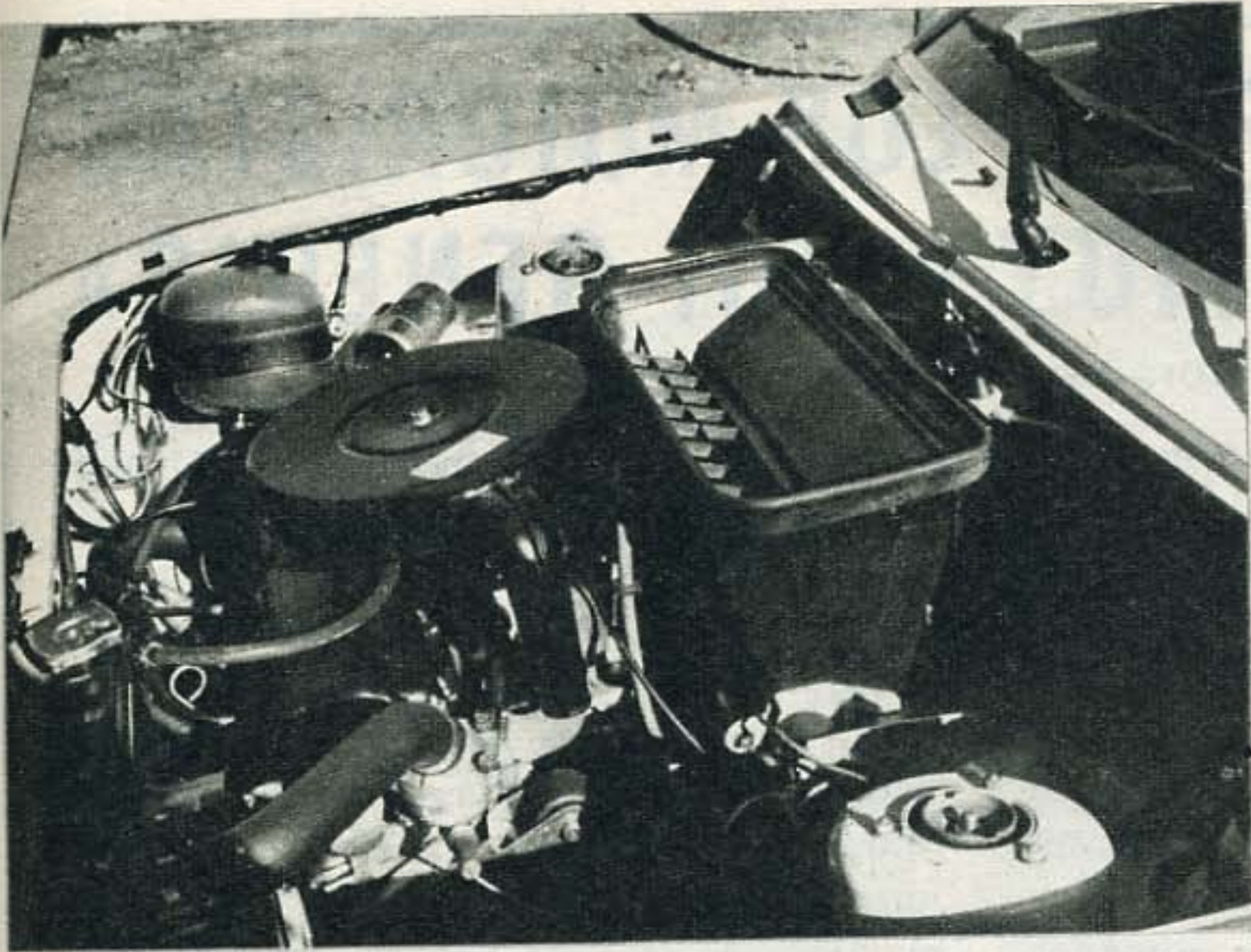
En el vano del motor se ha dejado espacio para montar servofreno para quien así lo desee. Puede apreciarse el sistema de calefacción, de gran rendimiento.
