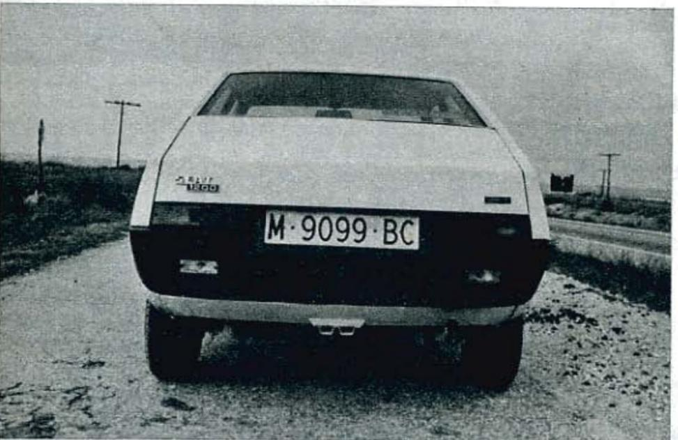
Visto por atrás se muestra la poca altura de la luneta y el consistente parachoques de poliuretano, que incluye los faros de marcha atrás.
