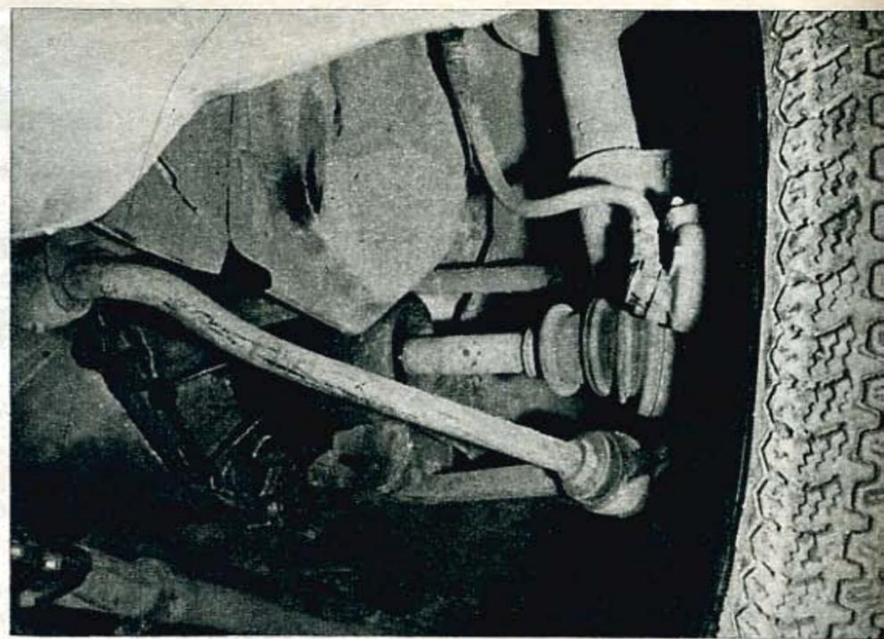
Detalle de la suspensión McPherson delantera y de la barra estabilizadora.
