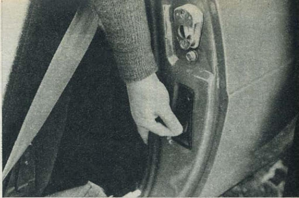
Dispositivo de apertura del maletero, con un tirador situado en el vano de la puerta del conductor.
