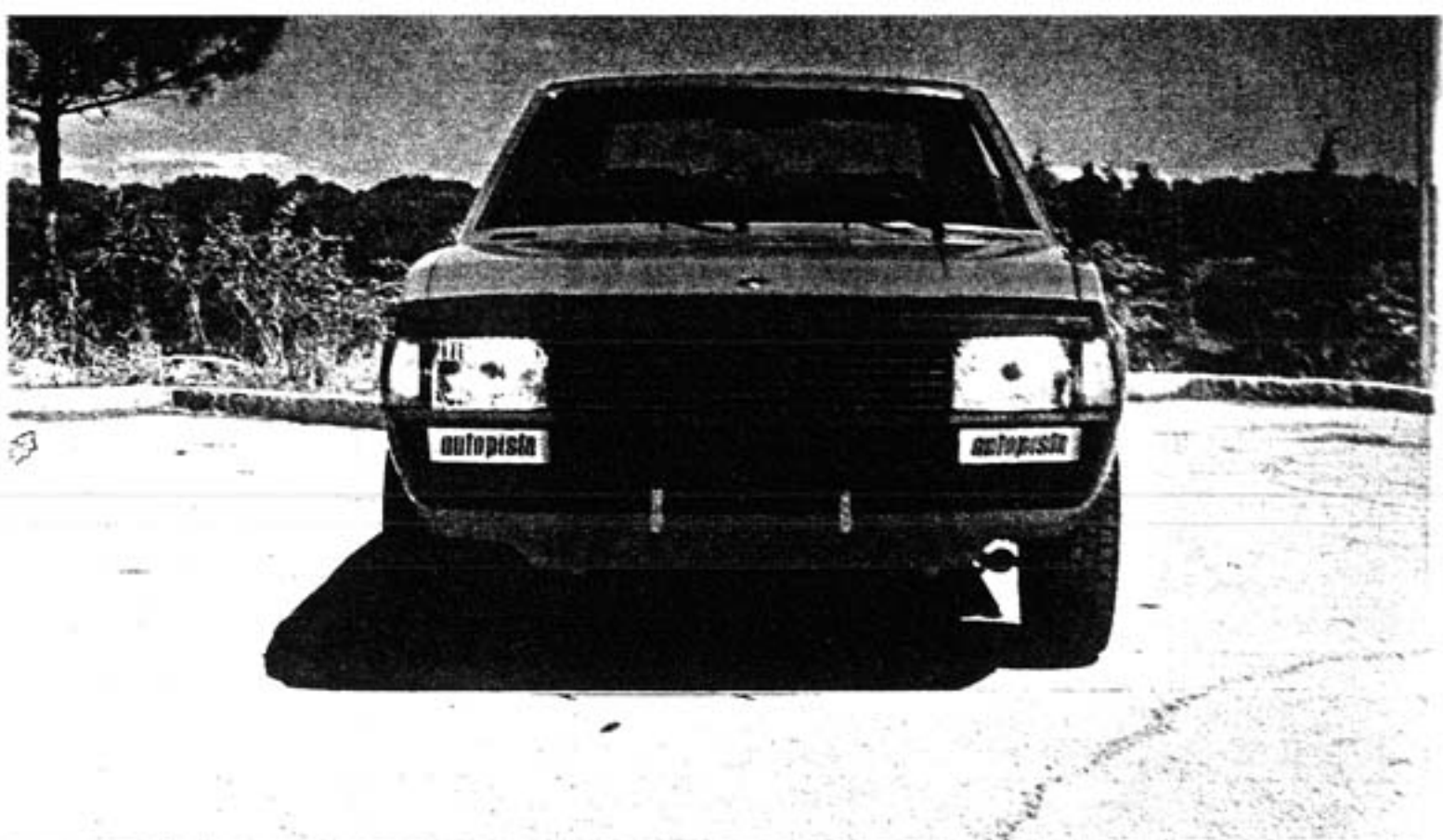
Estas luces son inadecuadas para un coche de gran estabilidad y capaz de superar los 160 km/h., con gran poder de aceleración. Dado el diseño del frontal, no hay más que una solución: faros H-4.
