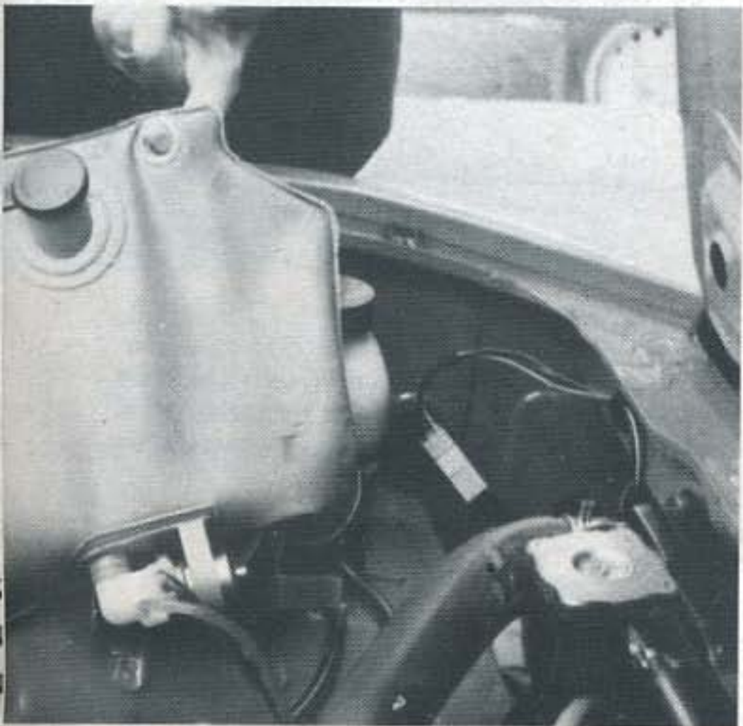
▲ El lavaparabrisas lleva bomba eléctrica para la salida del agua.
