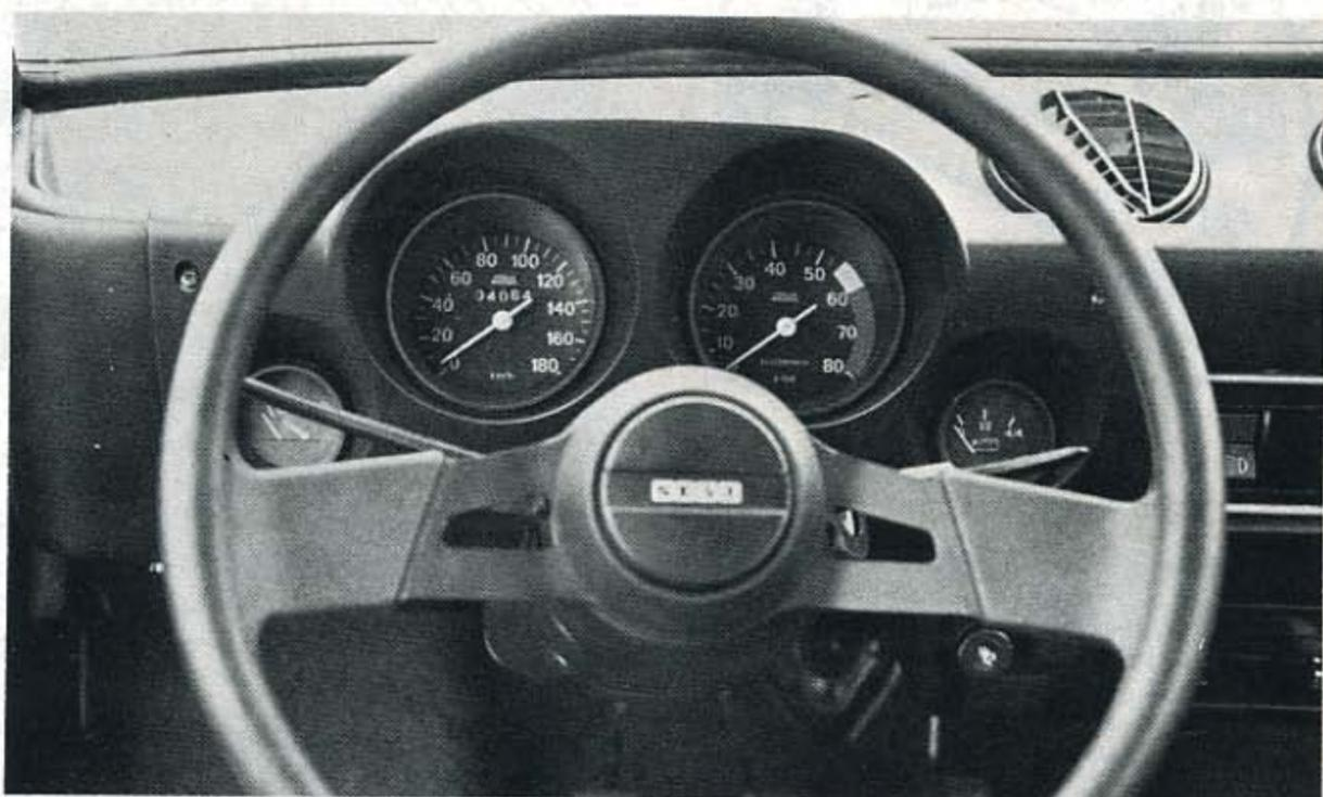
Cuadro de instrumentos formado por dos esferas grandes y otras dos más pequeñas para la medida de la temperatura y el nivel de combustible.
