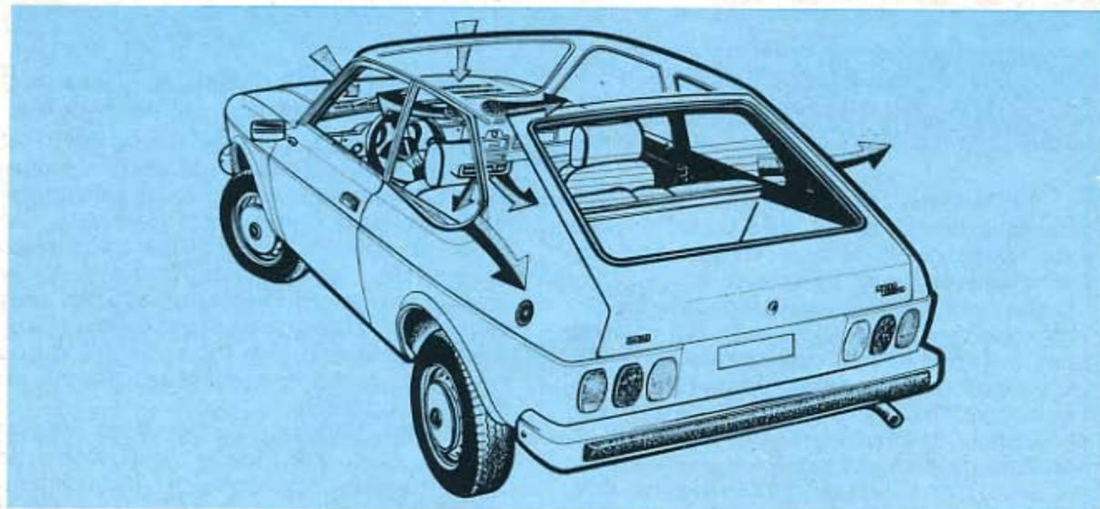
*Circuito completo de ventilación y calefacción. El aire entra por las rejillas en el capot, después de pasar por el radiador de la calefacción entra al interior a través de los difusores del salpicadero y por la parte baja de la consola. Al fin sale por las ventanillas posteriores laterales.*
