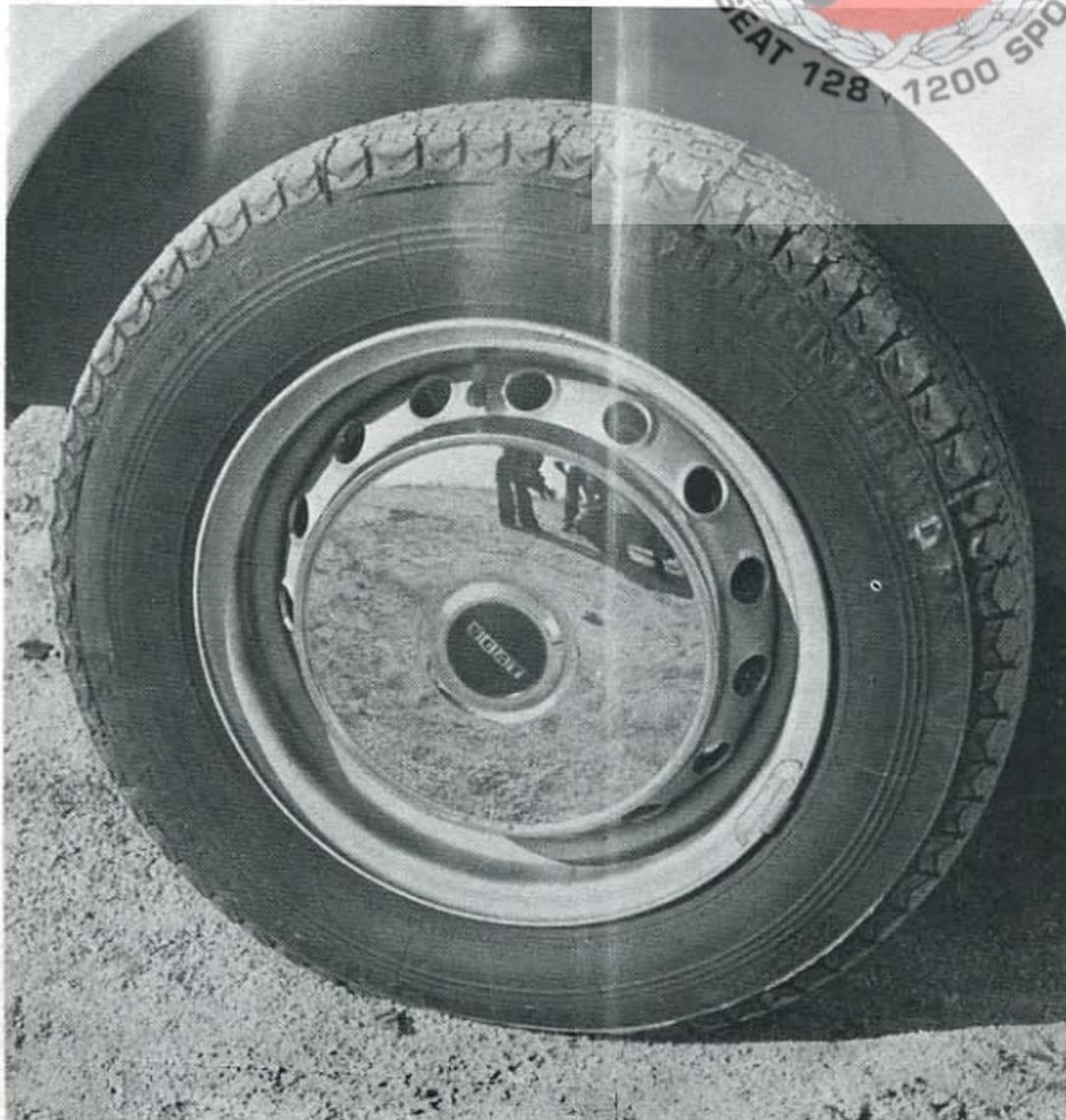
Ruedas de chapa estampada con perforaciones para facilitar la evacuación de calor de los frenos.
