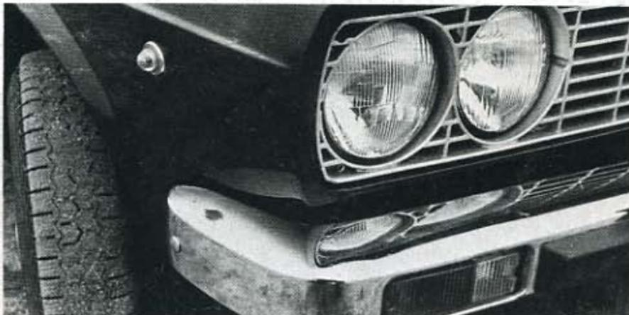
Conjuntos ópticos delanteros: faros para los haces de "cruce" y "carretera", piloto con luz de posición e intermitencia frontal y, a la izquierda, intermitencia lateral.
