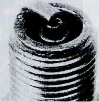
**Bujía engrasada.** La presencia de aceite puede indicar desgaste de segmentos o guías de válvulas. Póngase otras más calientes.
